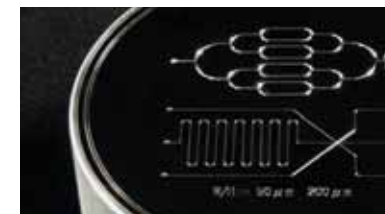
マイクロ流路 超精密曲線溝加工 溝幅50μm、及び200μm
