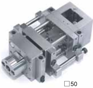
JFTの金型は98×98mmと120×120mmサイズが標準の大きさです。重量は約7kg～12kg、持ち運びも取り付けも簡単です。
