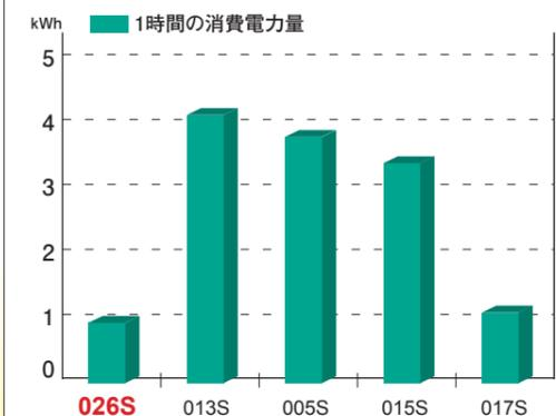
JMW-013S-10t、JMW-005S-10t、JMW-015S-5t、JMW-017S-1.5t各機種と比較した結果、本機は型締力1.5tの従来機より更に低い消費電力での稼働が可能であると実証されました。
